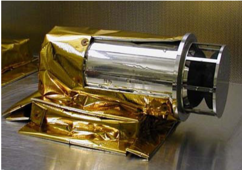
10.105. ASPERA kurz vor dem Einbau in die Sonde Venus Express
